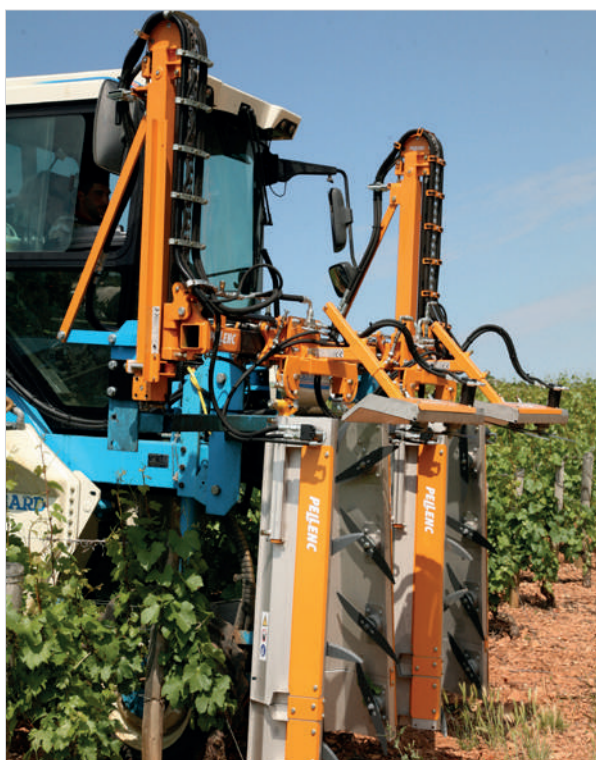
MULTIVITI despuntadora 2 hileras, con despuntadoras hidráulicas
