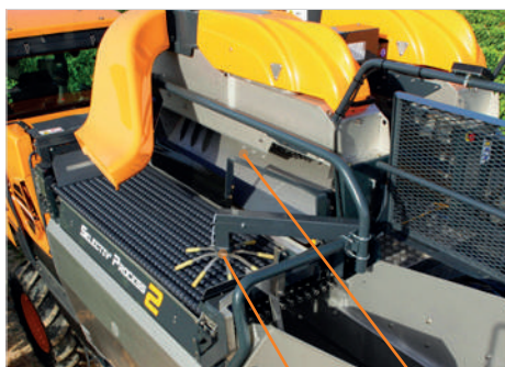
Deflector vibratorio y repartidor giratorio: separador de calidad en condiciones difíciles, incluso a gran velocidad.
