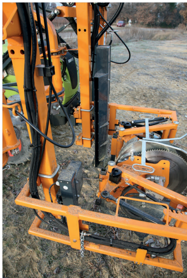
Seguimiento automático del cordón por visión
