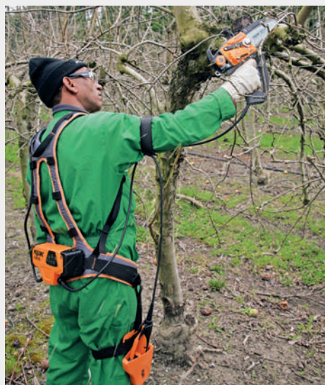
Poda en un huerto con la SELION M12 y la PRUNION con batería ULIB 250 para un trabajo alterno.
