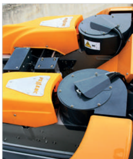
Aspiradores superiores (opcionales) regulables en potencia y retráctiles para lavarlos
