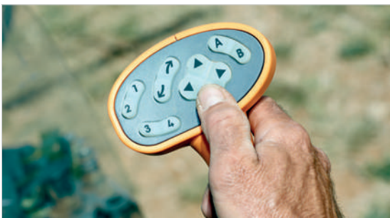
Joystick multifunción de serie. Control en 1 clic de todas las funciones de la despuntadora.
