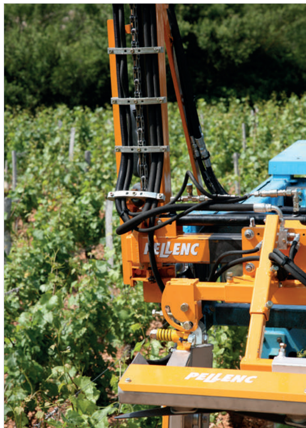
Guía de los conductos flexibles por cadena inoxidable
