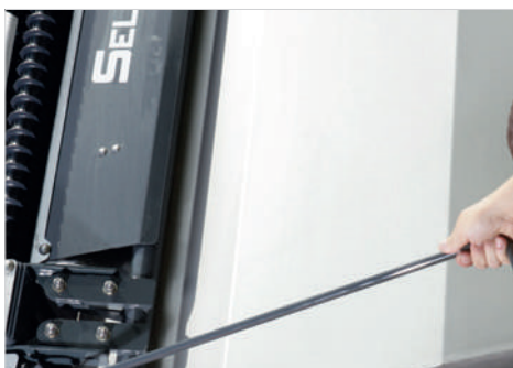
Ajuste de la separación de los rodillos de selección con cursor indicador
