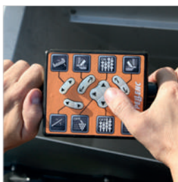
Mando remoto en el cabezal de recolección
