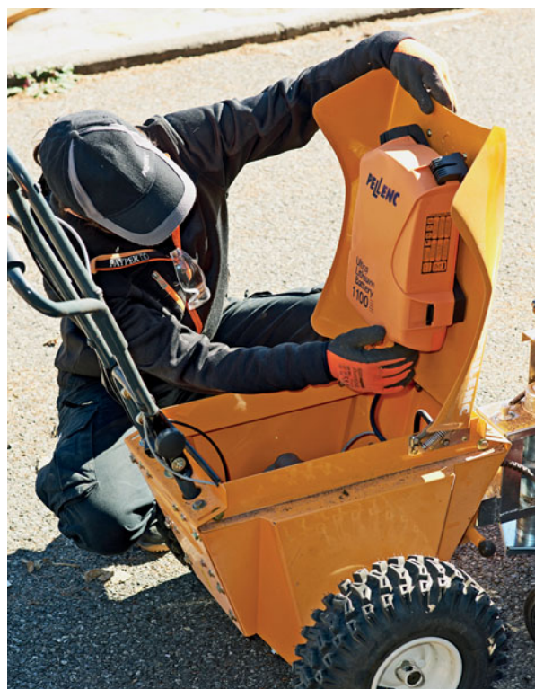
Accès facilité à la batterie, protégée dans son habitacle
