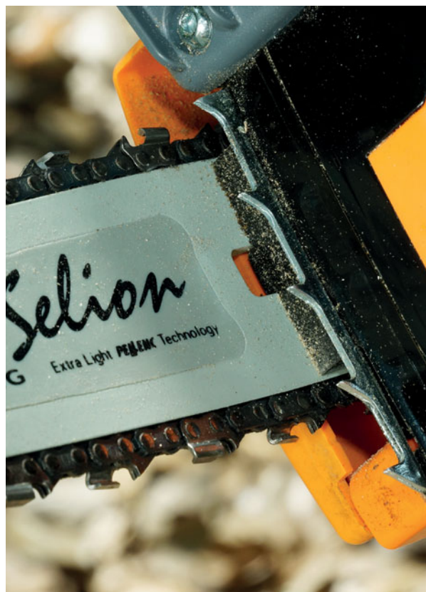
La griffe sert de pivot pour une attaque plus efficace
