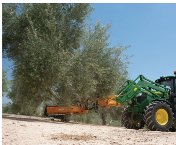
Dégagement important, le tracteur ne roule pas sur les olives tombées au sol
