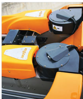
Aspirateurs hauts (option) réglables en puissance et escamotables pour le lavage
