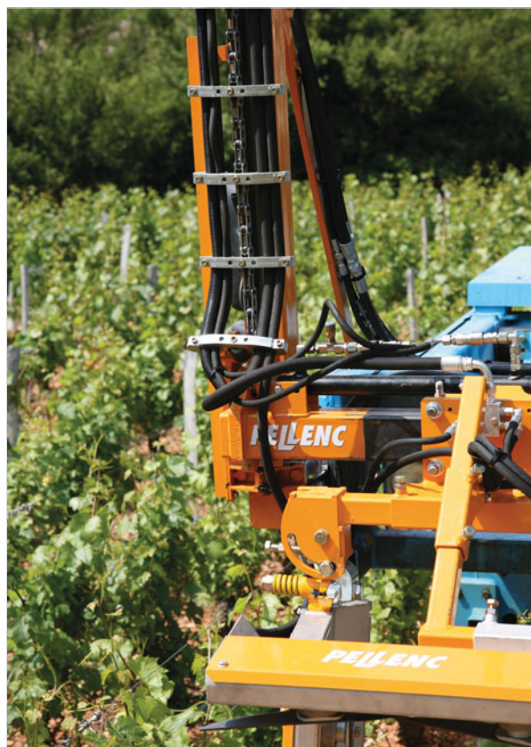
Guidage des flexibles par chaîne Inox
