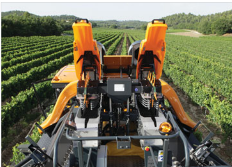
Débrayage instantané, depuis le pupitre EASY TOUCH, des égreneurs, aspirateurs hauts et tables de tri.
