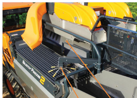
Défecteur et bande transporteuse du trieur égreneur vibrant.
