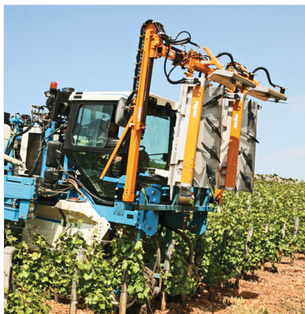
Relevage vertical des écimeuses
