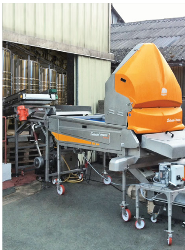
Extractiv' sur châssis à roulette derrière Selectiv' Process Vision
