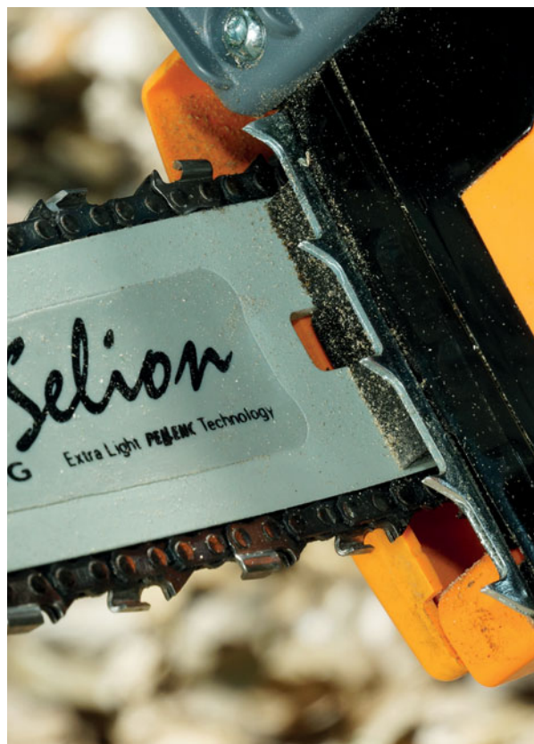
De klauw dient als spil voor een doelmatigere aanzet
