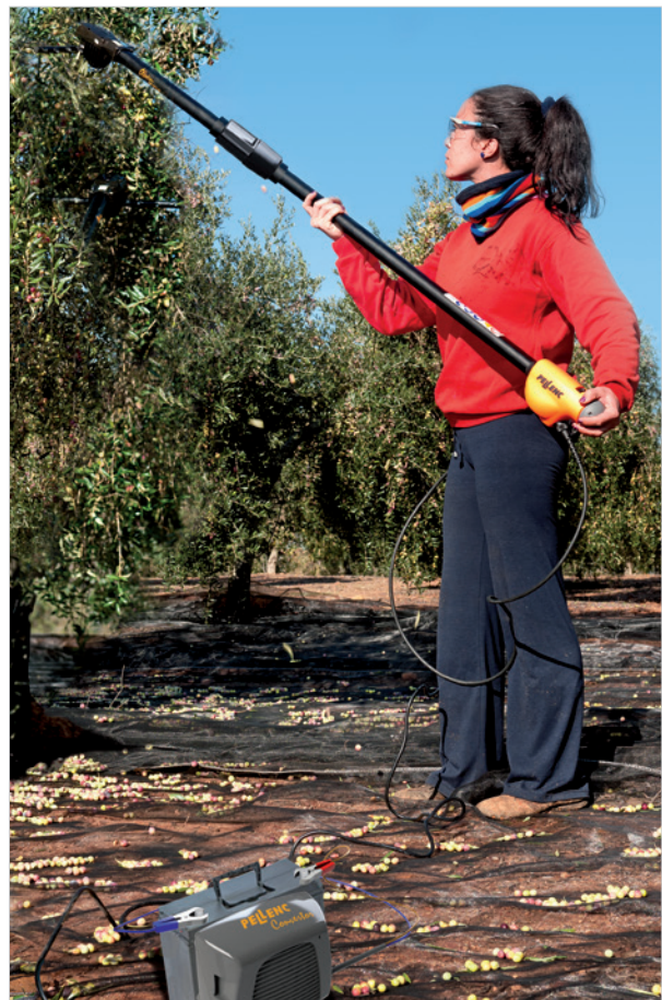
Betrieb ohne Akku auf dem Rücken dank 12-Meter-Verlängerungskabel
