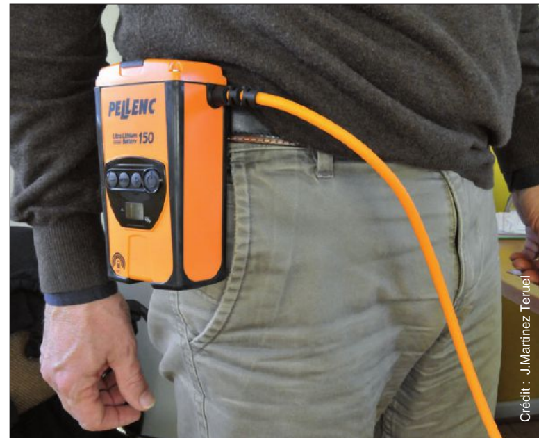
La batterie Ulib 150, qui pèse 845 g, peut s'accrocher à la ceinture.
