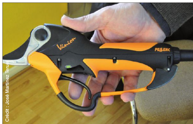
La nouvelle tête de coupe du sécateur (Pradines) permet un diamètre de coupe de la lame de 35 mm pour une ouverture totale de 57 mm.
