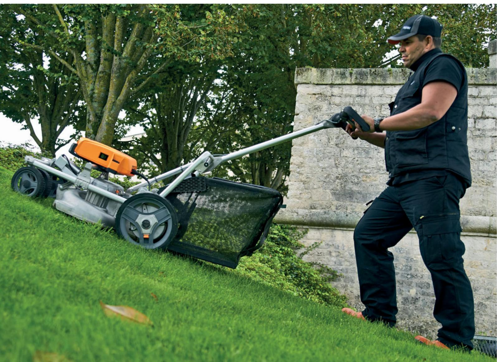
*Ligero y sencillo de manejar, el cortacésped RASION SMART tiene un motor independiente en cada una de la ruedas traseras para facilitar el trabajo en zonas en pendiente e inclinadas*
