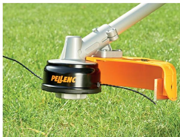
Cabezal Roll Cut con hilo de poliamida en espiral
