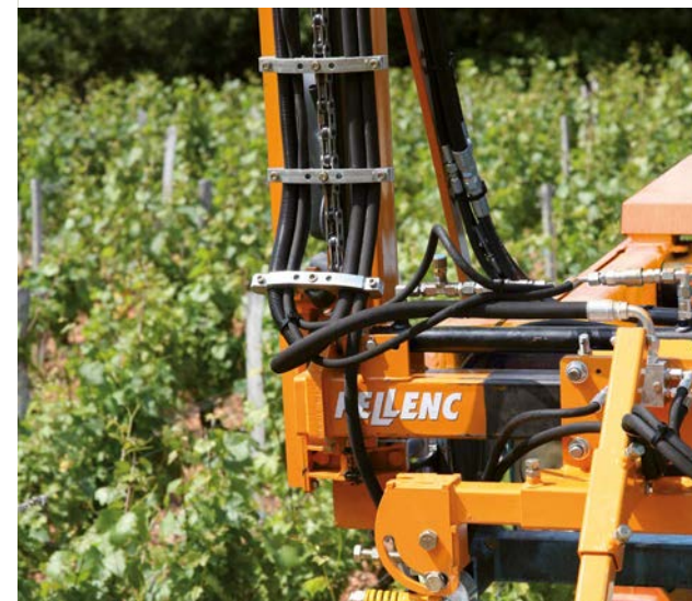
Guidage des flexibles par chaîne Inox
