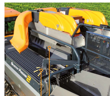
Défecteur et convoyeur à claire-voie du trieur égreneur vibrant.
