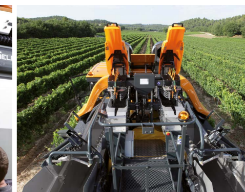
Débrayage instantané, depuis le pupitre EASY TOUCH, des égreneurs, aspirateurs hauts et tables de tri.
