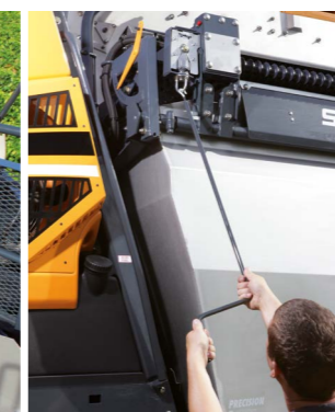
Réglage de l'écartement des rouleaux cribles avec curseur d'indication.
