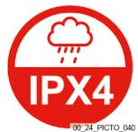
Grado de protección IPX4: el producto es apto para todo tipo de condiciones meteorológicas y es resistente a las salpicaduras de agua fuertes. Sin embargo, no resiste la inmersión.
