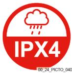
Indice de protection IPX4 : le produit est adapté à toutes les conditions climatiques et résiste aux fortes projections d'eau. Cependant, il ne résiste pas à l'immersion.
