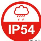
Indice di protezione IP54 dell'utensile in posizione di lavoro con batteria o contrappeso (protezione contro la polvere e le proiezioni d'acqua in tutte le direzioni).
