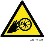
No introducir los dedos ni ninguna clase de objeto en la rejilla de entrada del aire. Cuando la rejilla de admisión no esté montada, existe el riesgo de contacto con las piezas en rotación - riesgo de sufrir lesiones - se pueden dañar los elementos giratorios.
