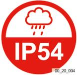
Índice de protección IP54 de la herramienta (protección contra el polvo y las salpicaduras de agua en todas direcciones), no se refiere a la batería.
